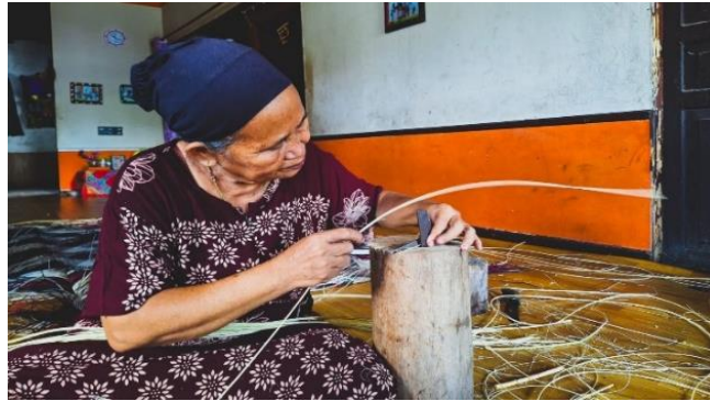
Gambar 7. Proses menghaluskan permukaan rotan
